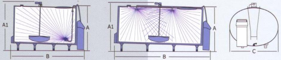
Per i modelli O 2000 e superiori, i serbatoi sono dotati di sfera di lavaggio (con tubazione di lavaggio staccabile)
